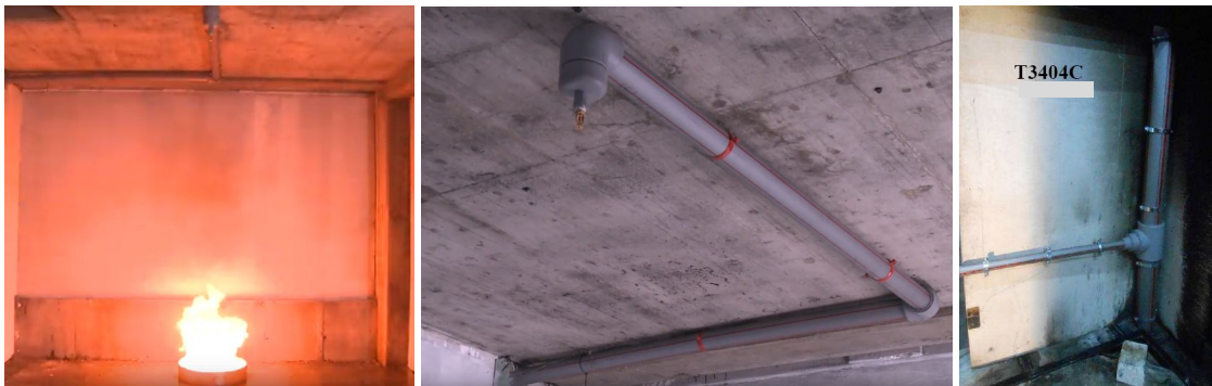
Montajes habituales de la homologación de los sistemas plásticos para su uso en redes contra incendios en los ensayos de exposición (Anexo D2 del RP 01.84) y reacción al fuego (UNE-EN 13823 y UNE-EN 11925).
