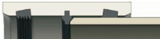
Figura 1. Detalle general y sección del manguito de PRFV (Tipo REKA)
