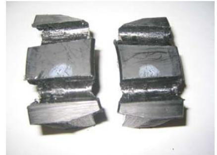
Fig.4.6 Típica rotura frágil
