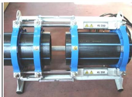
1. Colocar el tubo en la máquina
