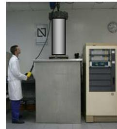
Fig. 4.11 Ensayo presión interna
