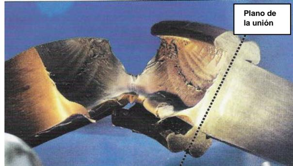
Fig. 1.- La rotura no se produce en el área soldada
