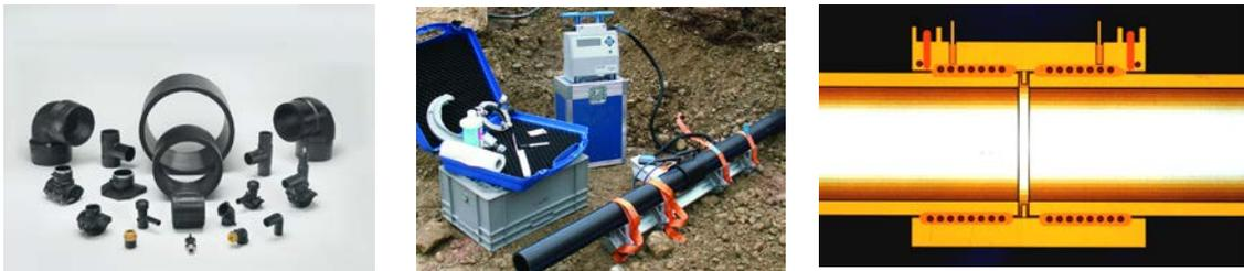
Figura 2.1.- Soldadura con accesorios electrosoldables
