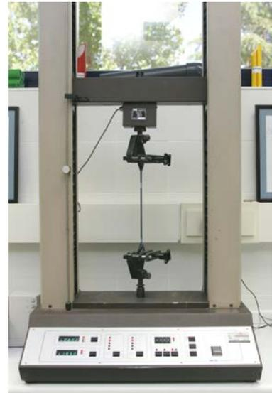
Fig.4.7 Ensayo de resistencia a la tracción y alargamiento
