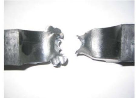
Fig.4.5 Típica rotura dúctil
