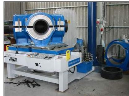
Fig. 3.2 Máquina de soldar a tope de taller para fabricar accesorios manipulados
