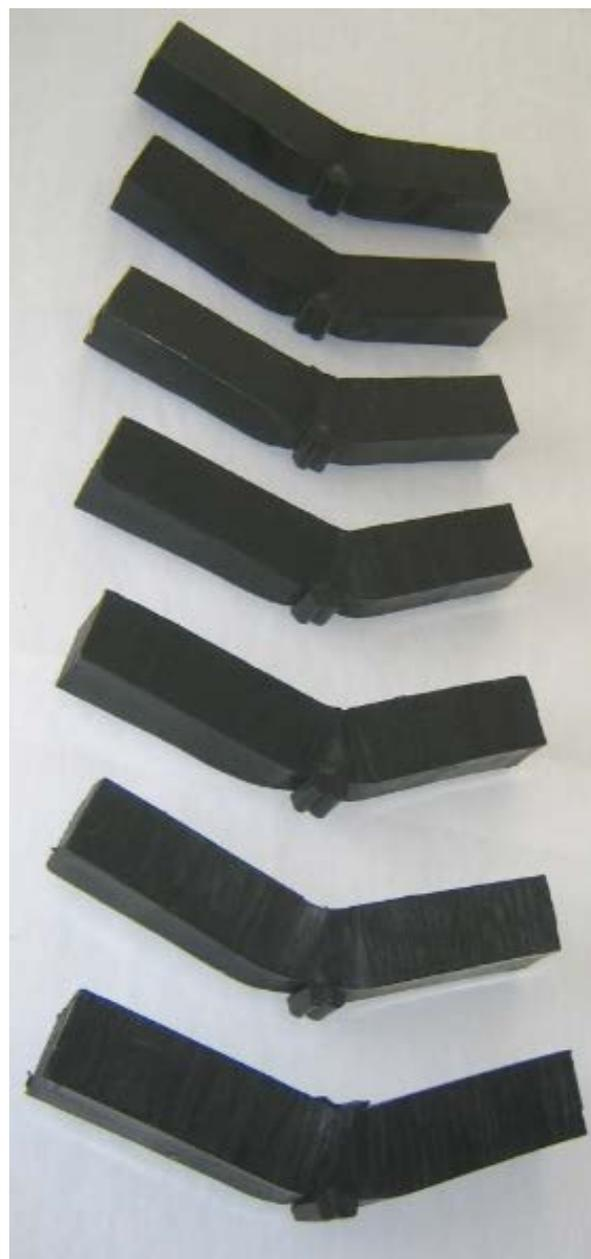
Fig. 4.16. Ensayos Curvatura según UNE-EN 12814-1 (DVS 2203-5)
