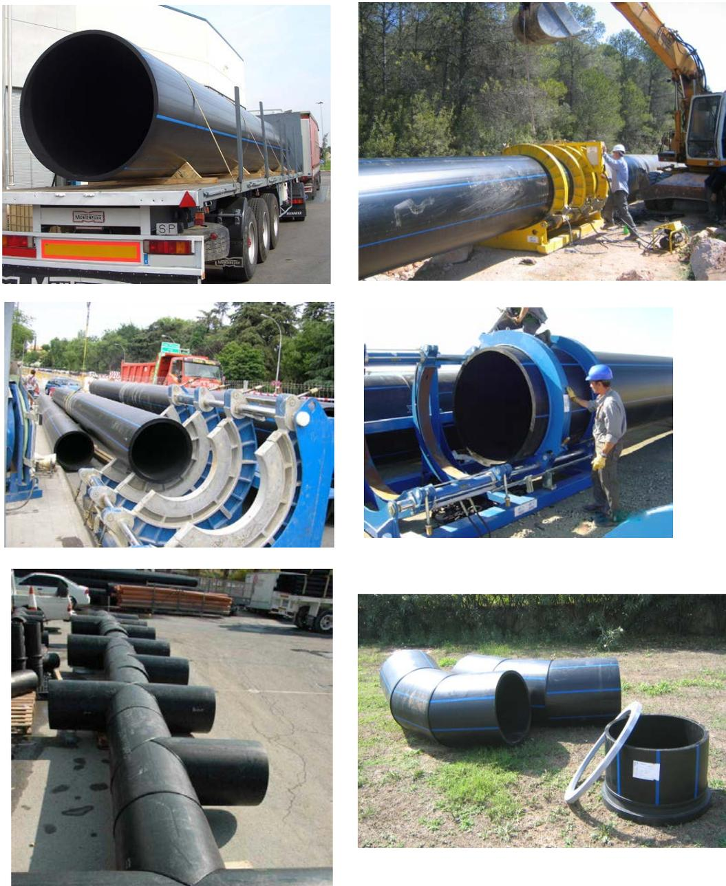
Fig. 4.17. Tubos de PE de gran diámetro
