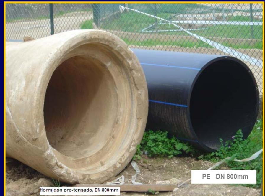
Hormigón pre-tensado, DN 800mm
